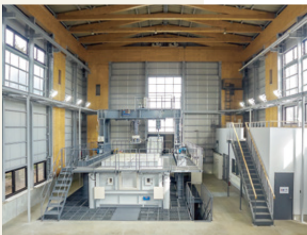
筑波研究所にある耐火試験専用の検証棟。大型部材の耐火試験が可能になった
