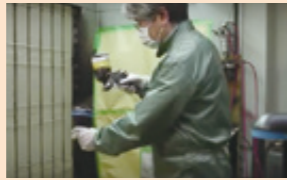
スプレーで漆を均一に塗る技法を開発
